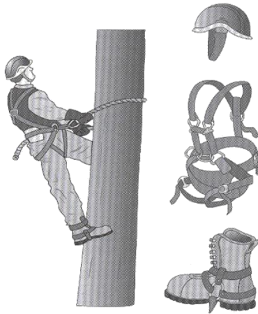
ภาพ ตัวอย่างอุปกรณ์นิรภัยสำหรับใช้ในการปีนต้นไม้ ที่มา: Draft Code of practice on safety and health in forest work (Geneva, ILO, ๑๙๙๗), p. ๖๒.
