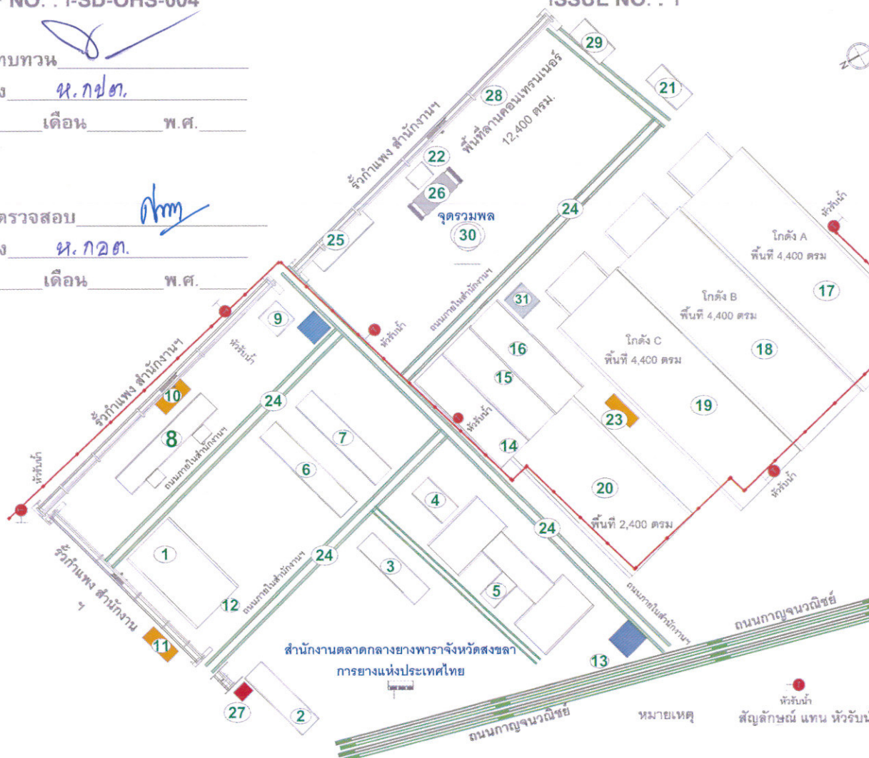
แผนภาพแสดงจุดติดตั้ง วาล์วน้ำ และตู้ดับเพลิง บริเวณโกดัง A, C
