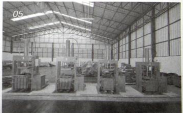
01. ยางแผ่นรมควันของสหกรณ์เครือข่ายวิสาหกิจ 5 แห่ง หลังจากคัดคุณภาพ จะถูกส่งเข้าสู่โรงงานอัดก้อนของเครือข่าย ซึ่งทั้งหมดมีคุณภาพเดียวกัน 02. ธุรกิจหลักของสหกรณ์เครือข่ายวิสาหกิจ คือ รวบรวมน้ำยางสดผลิตเป็นยางแผ่นรมควัน 03. เครื่องอัดก้อน ขนาดก้อนละ 35 กก. สำหรับผู้ใช้ภายในประเทศ 04. เครือข่ายวิสาหกิจตั้งเป้าผลิตยางแผ่นรมควัน ปีละ 4,000 ตัน 05. เครื่องอัดก้อนยางแผ่นรมควัน
