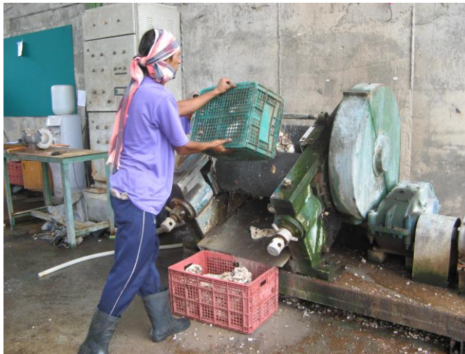
ภาพที่ 19 รีดยางก้อนถ้วยผ่านเครื่องรีดเครพ
