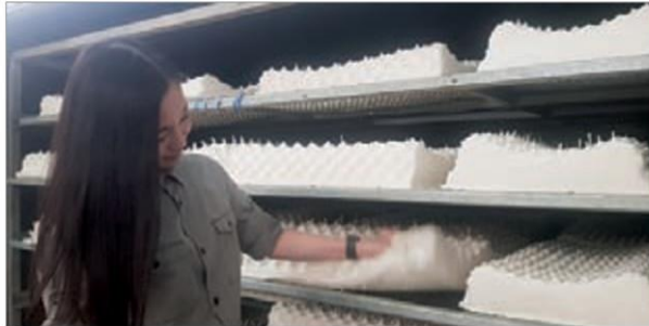
หมอนยางพาราที่แกะออกจากพิมพ์เข้าเครื่องซัก บั่น แล้วนำเข้าเตาอบ ฉวีวรรณ คงแก้ว
