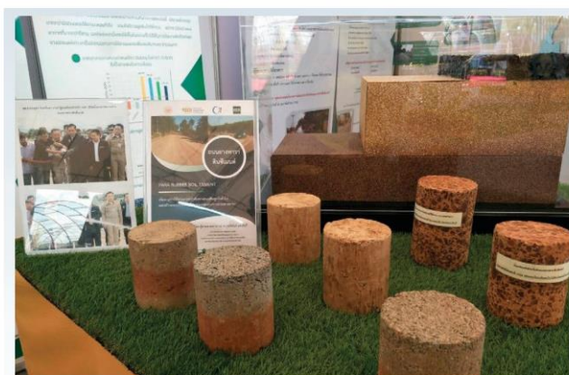
ต้นแบบ ถนนยางพาราดินซีเมนต์ งานวิจัยที่ไม่เคยหยุดพัฒนา จาก มจพ.
