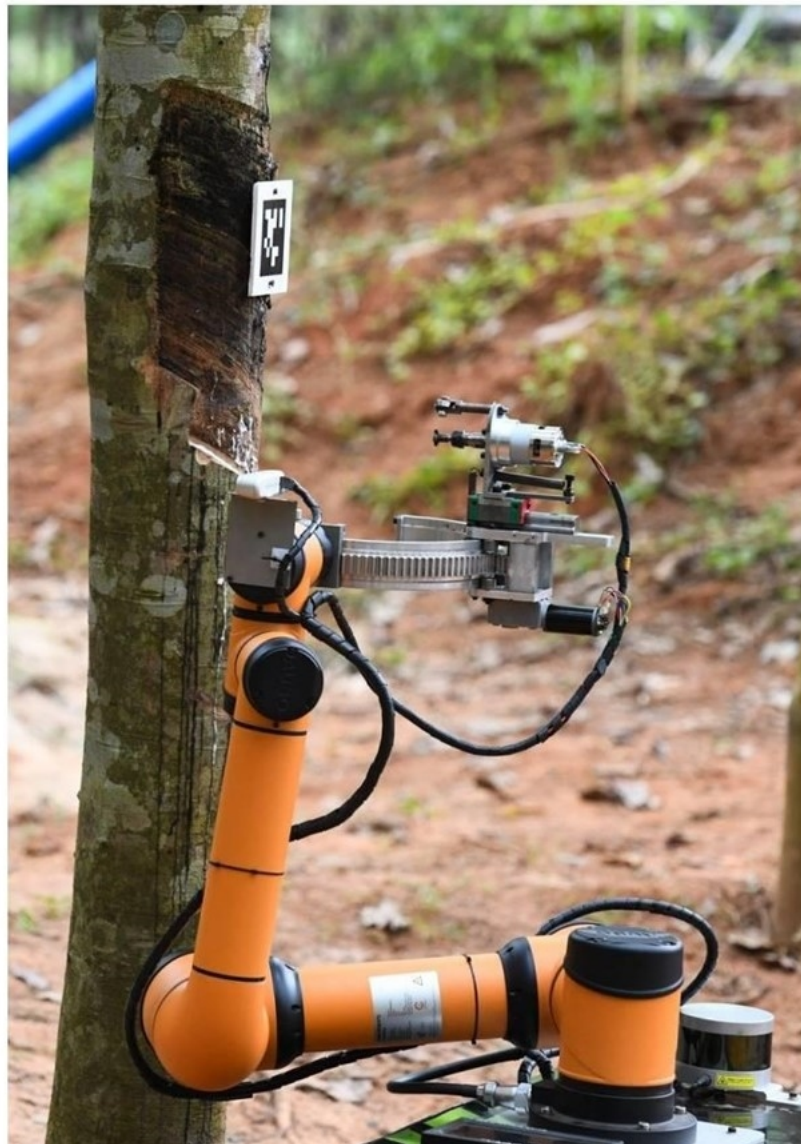
(แน้มภาพขึ้นทิว : หุ่นยนต์กรีดยางอัตโนมัติที่สวนยางใกล้บริษัทอุตสาหกรรมยางธรรมชาติ ในมณฑลไต้หวันทางตอนใต้ของจีน วันที่ 19 ก.ย. 2019)
