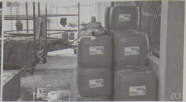
02. โรงผลิตยางแผ่นรมควัน รองรับน้ำยางสดจากสมาชิก 10-15 ตัน/วัน 03. "กรดพอร์มิก ตรา ม้าแดง" สหกรณ์แห่งนี้ใช้มานาน ช่วยให้ยางแผ่นส่วนใหญ่อยู่ในคุณภาพชั้น 3 04. บางช่วงปริมาณน้ำยางค่อนข้างเยอะ จนเตารมควันที่มีอยู่ 4 ห้อง ไม่เพียงพอ จึงต้องส่งน้ำยางขายเข้าโรงงาน 05. คุณภาพเป็นเรื่องสำคัญ เพราะระหว่างการผลิตยางให้ได้เกรดสูง กับยางเสียตกเกรด ต้นทุนการผลิตเท่ากัน 06. สหกรณ์ได้งบประมาณจัดสร้างยางแผ่นรมควันอัดก้อน เป็นการแปรรูปยางเบื้องต้นสำหรับส่งออก ซึ่งสหกรณ์แห่งนี้มีศักยภาพเพียงพอ
