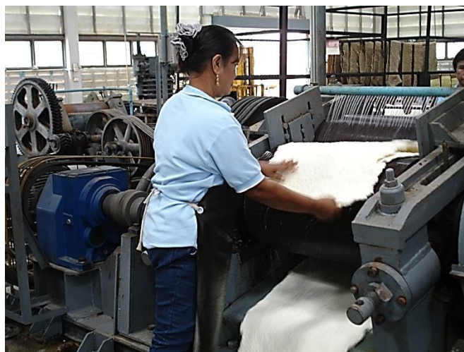
ภาพที่ 7 ขั้นตอนการผลิตยางเครพจะมีน้ำชะล้างตลอดการรีด
