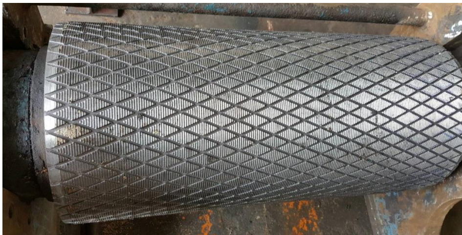
ภาพที่ 3 เครื่องเครพดอกกลางและดอกมีการเซาะร่องเกลียว
