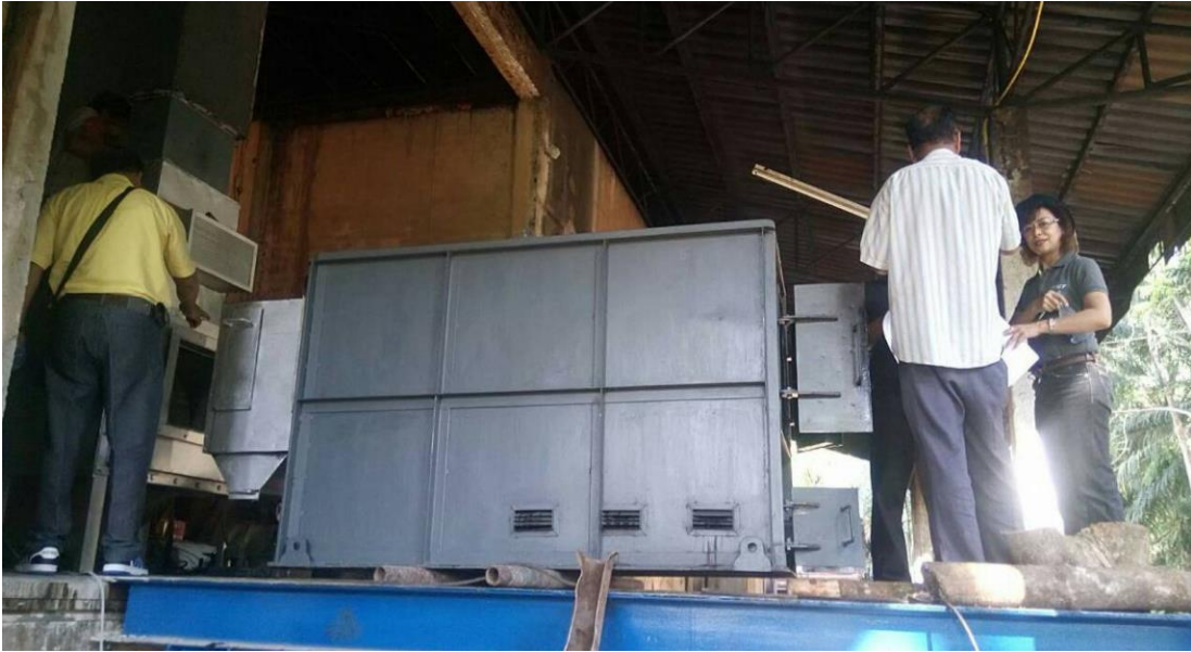
ภาพที่ 21 ด้านข้างเตาเผาทรงนอน ช่องส่วนล่างเป็นช่องอากาศเพื่อเพิ่มประสิทธิภาพการเผาไหม้
