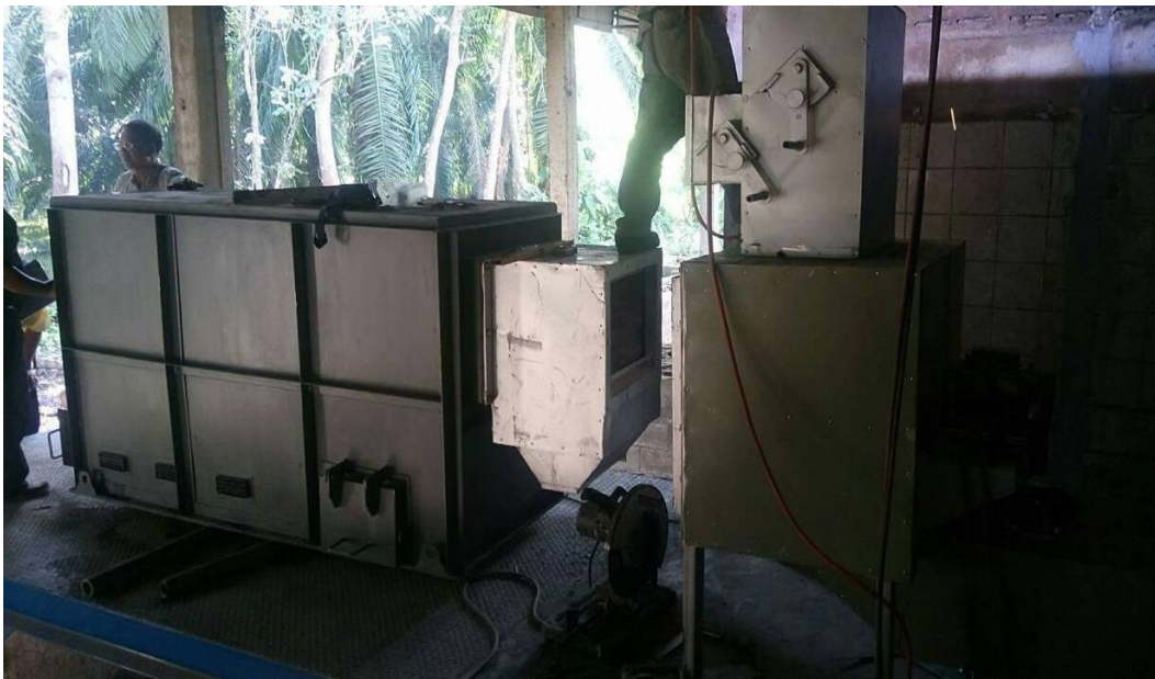
ภาพที่ 22 ส่วนดักสะเก็ดไฟต่อเชื่อมระหว่างเตาเผากับพัดลมดูด
