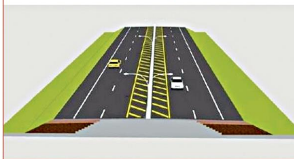
เกาะกลางแบบกำแพงคอนกรีตหุ้มด้วยแผ่นยางธรรมชาติ
