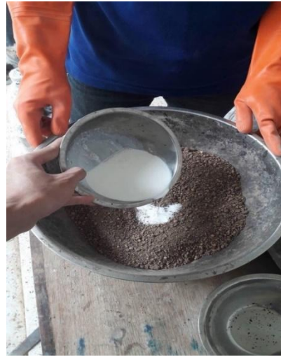
รูปที่ 4 แสดงการผสมน้ำยางพาราผสมสารผสมเพิ่มกับดินซีเมนต์
