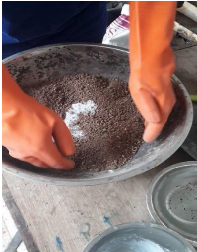
รูปที่ 4 แสดงการผสมน้ำยางพาราผสมสารผสมเพิ่มกับดินซีเมนต์
