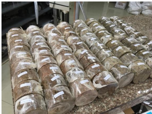
รูปที่ 5 แสดงการเตรียมก้อนตัวอย่างเพื่อนำมาทดสอบคุณสมบัติเชิงวิศวกรรมในห้องปฏิบัติการ
