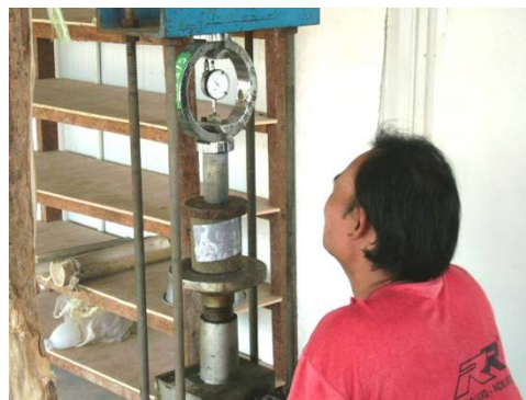
รูปที่ 3 แสดงการทดลองหาค่ากำลังรับแรงอัดของดินซีเมนต์ผสมยางพาราโดยวิธี Unconfined Compressive Test
