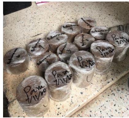
รูปที่ 5 แสดงการเตรียมก้อนตัวอย่างเพื่อนำมาทดสอบคุณสมบัติเชิงวิศวกรรมในห้องปฏิบัติการ
