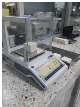
รูปที่ 3.6 การทดสอบความหนาแน่นของชิ้นงานยางพองน้ำ จากการวัดมิติด้วยเครื่องเวอร์เนียร์ และชั่งน้ำหนัก จากนั้นคำนวณหาความหนาแน่นของชิ้นงานพองน้ำ
