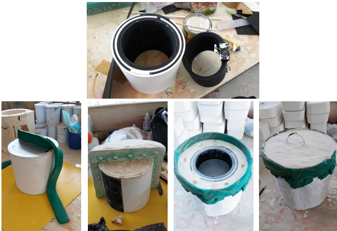
รูปภาพที่ 2 แสดงรูปการปั้นแล้วสร้างเข้าพิมพ์จากปูนปลาสเตอร์
