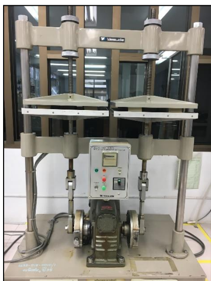
รูปที่ 3.9 การทดสอบยุบตัวเนื่องจากแรงกด ด้วยเครื่อง Foam Rubber Repeated Compression Tester
