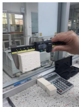
รูปที่ 3.6 การทดสอบความหนาแน่นของชิ้นงานยางพองน้ำ จากการวัดมิติด้วยเครื่องเวอร์เนียร์ และชั่งน้ำหนัก จากนั้นคำนวณหาความหนาแน่นของชิ้นงานพองน้ำ
