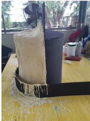
การสร้างเบ้าพิมพ์เปลือกเท้าสำหรับลูกข้าง (3)
