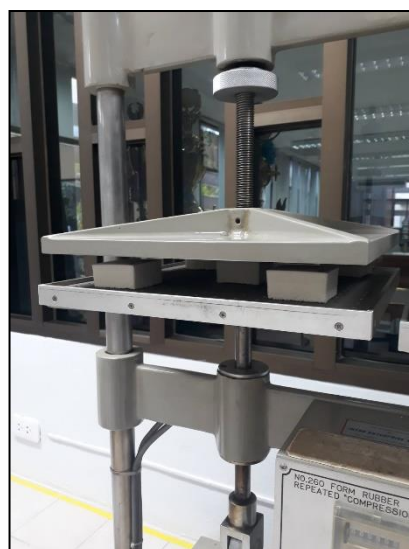
รูปที่ 3.9 การทดสอบยุบตัวเนื่องจากแรงกด ด้วยเครื่อง Foam Rubber Repeated Compression Tester
