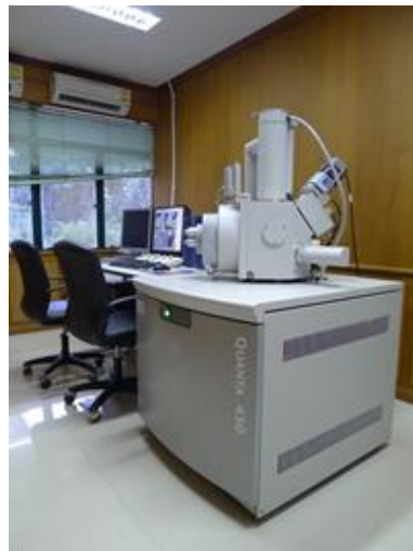
รูปที่ 3.11 การศึกษาลักษณะโครงสร้างสัณฐานวิทยาของยางพองน้ำด้วยเทคนิคกล้องจุลทรรศน์อิเล็กตรอนแบบส่องกราด (Scanning Electron Microscope, SEM) ยี่ห้อ FEI รุ่น Quanta 450 ที่มีกำลังขยาย 6 ถึง 1,000,000 เท่า
