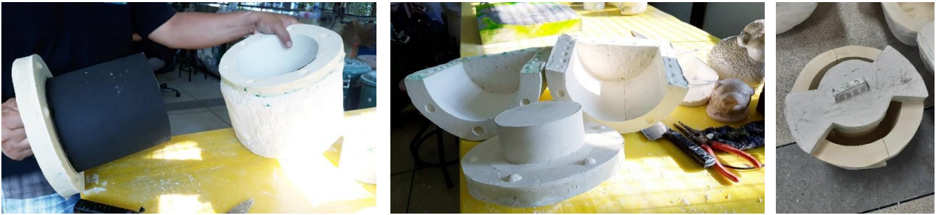
รูปภาพที่ 3 แสดงรูปการณ้ปั่นแล้วสร้างเข้าพิมพ์จากปูนพลาสติกอร์
