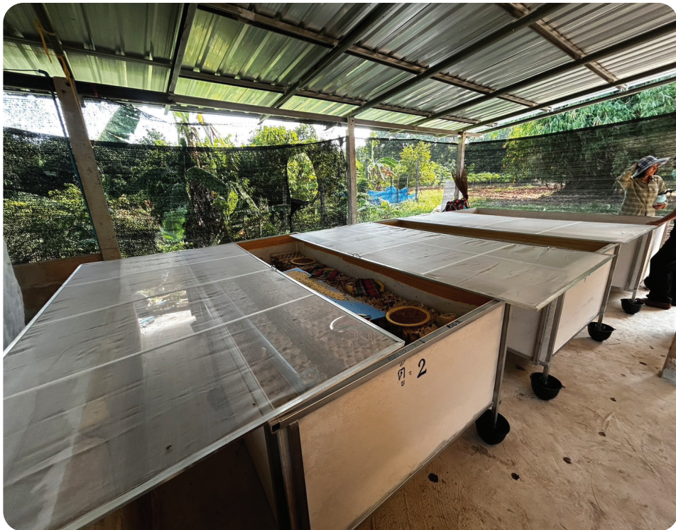
ภาพที่ 1 บ่อแบบกล่องโดยใช้กระเบื้องสมาร์ทบอร์ด มีฝาตะแกรงปิด และมีขาสูง 15-20 เซนติเมตร ใช้ถ้วยใส่น้ำรองขาป้องกันมด แมลง และสัตว์ชนิดอื่นที่อาจจะเข้ามารบกวนก่อนการจำหน่าย
